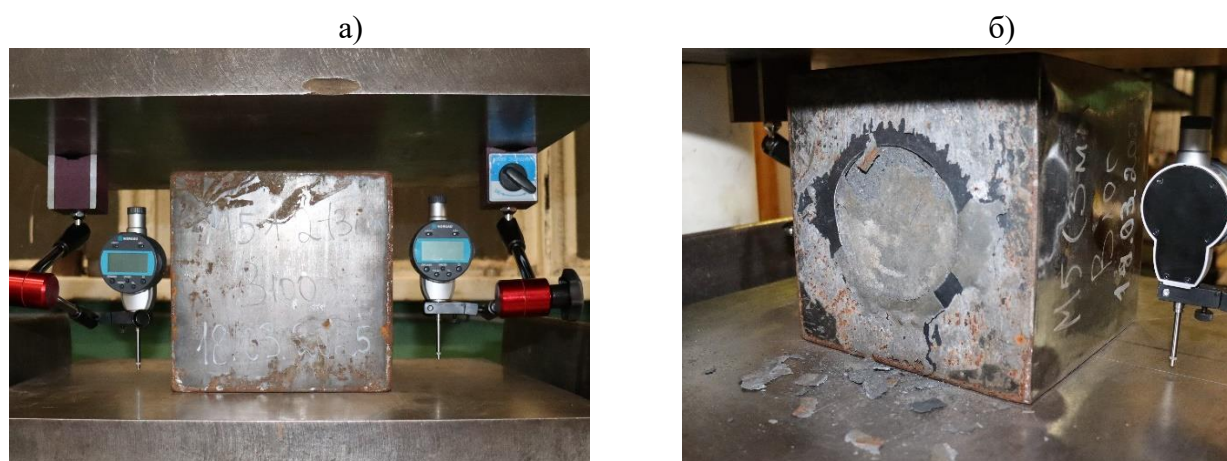
Рисунок 5 – Общий вид моделей-кубов, испытанных на одноосное сжатие.
