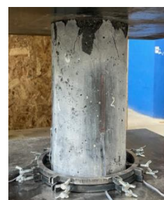
Рисунок 2б – Образец, доведенный до пиковой разрушающей нагрузки
