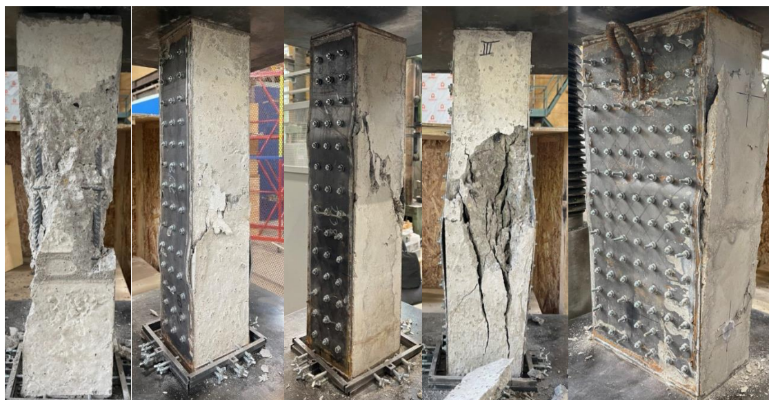
Рисунок 3 – Вид разрушения армированных образцов типов B, C, D, E, F
