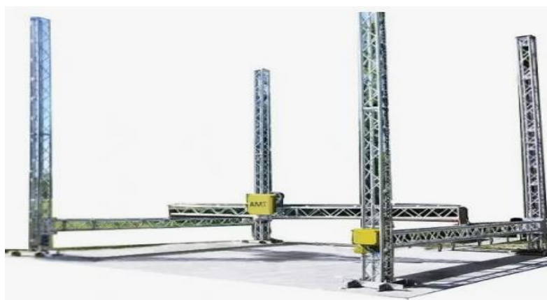
Рисунок 1 - Строительный 3D принтер козлового типа XYZ
