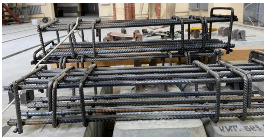
Рисунок 2 – Арматурный каркас полушпалы
