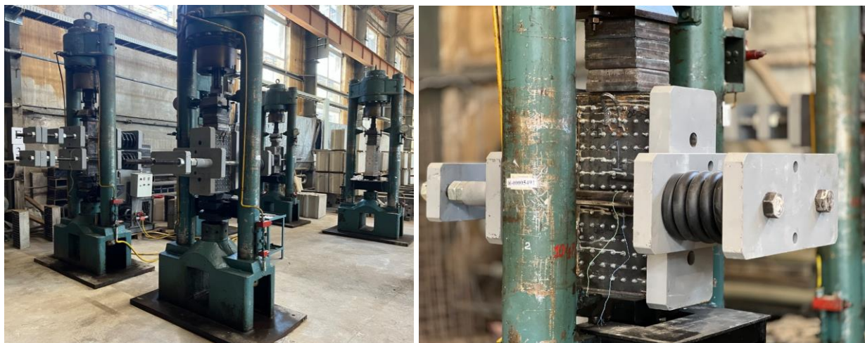
Рисунок 2 – Длительные испытания сталежелезобетонных образцов типа F в режиме двухосного сжатия
