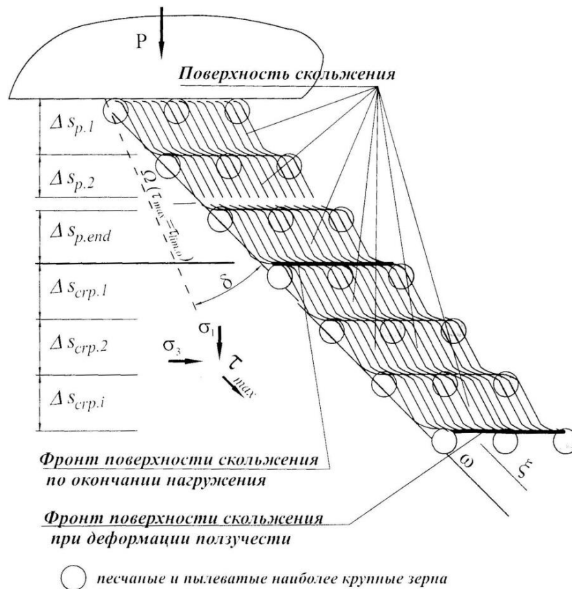
Рисунок 5 – Схема формирования поверхности скольжения на деформационных неоднородностях и приращений осадки на каждом шаге перемещения её фронта
