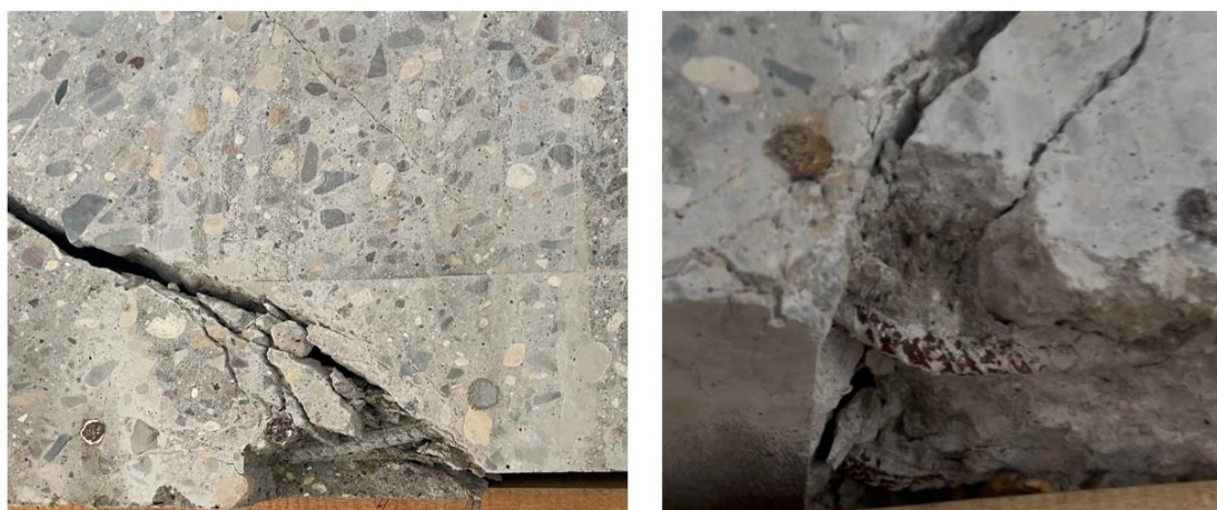
Рисунок 21 – Характер деформирования продольных арматурных стержней сжатой зоны плиты марки ККТ_1_№1 в процессе выдавливания пирамиды продавливания. Данные получены после распиловки образцов плит
