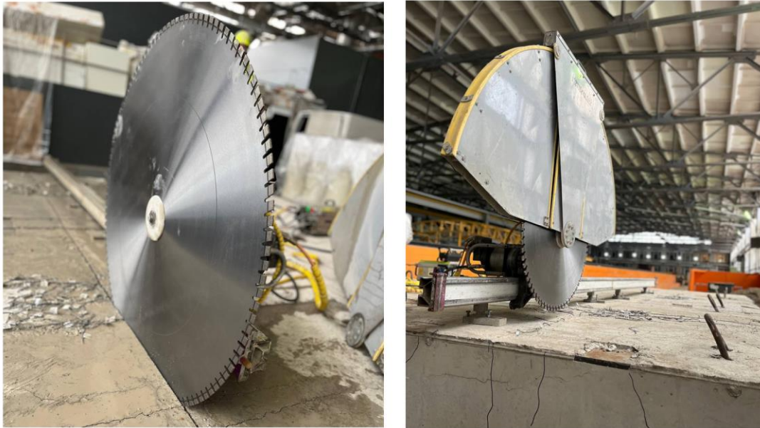
Рисунок 6 – Процесс резки экспериментальных образцов плит
