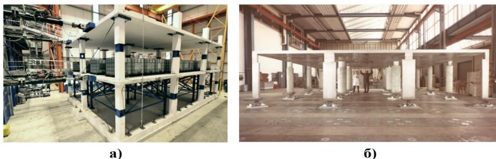
Рисунок 4 – Экспериментальные плиты перекрытий в составе фрагментов каркасов, состоящих из нескольких пролётов: а) [27]; б) [28]
