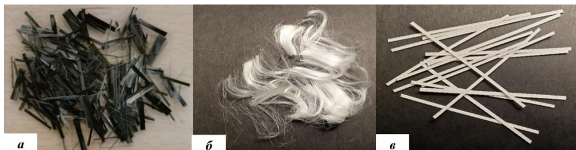
Рисунок 1 – Базальтовая фибра (а), синтетическая микрофибра «Fibrin XT» (б) и синтетическая макрофибра «Durus S500» (в)
