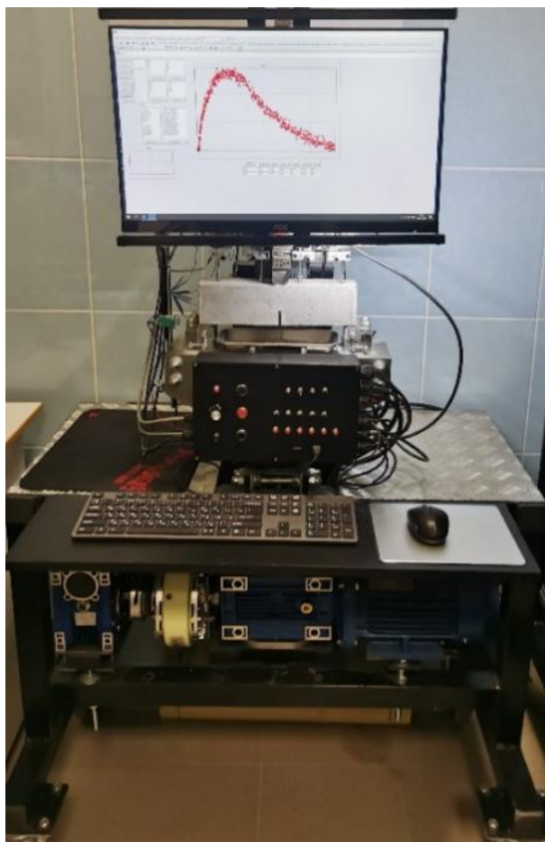
Рисунок 2 – Установка для определения характеристик трещиностойкости бетона
