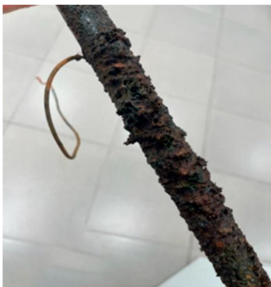
Рисунок 4 – Корродированный образец с продуктами коррозии
