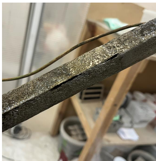
Рисунок 5 – Очищенный корродированный образец
