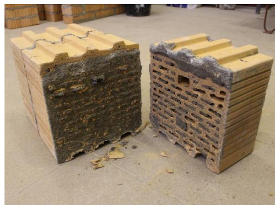
Рисунок 5– Результаты испытаний на сдвиг кладки из поризованных керамических блоков: а)– график зависимости « f_v – f_p »; б)– характер разрушения при f_p=0 МПа
