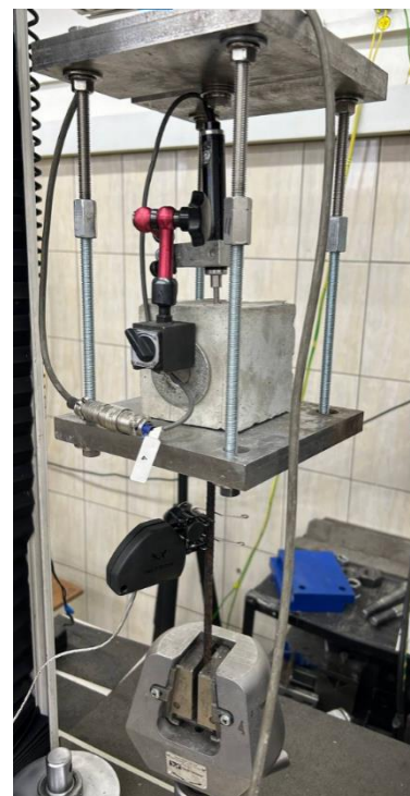
(с) образец без коррозии
