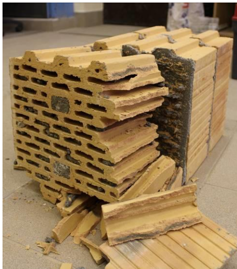
Рисунок 4– Характер разрушения образцов каменной кладки из поризованных керамических блоков при f_p=0,1 МПа
