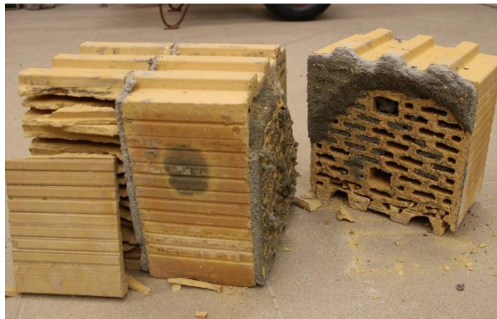
Рисунок 4– Характер разрушения образцов каменной кладки из поризованных керамических блоков при f_p=0,1 МПа
