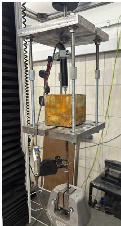
(б) образец с коррозией
