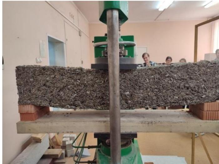
Рисунок 2 – Исследования прототипа армированной балки их ДЦК при изгибе
