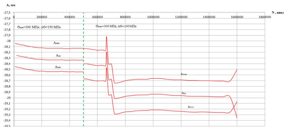
Рисунок 11 – Зависимость амплитуды перемещения активного захвата при циклических испытаниях арматуры А500С Ø 16 мм в бетоне
