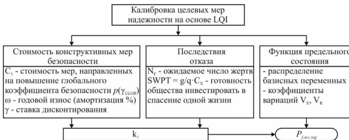
Рисунок 2 - Схема определения целевых значений вероятности отказа  $p_{f,acc}$  на основе LQI-критерия обеспечения безопасности жизнедеятельности согласно [10]
