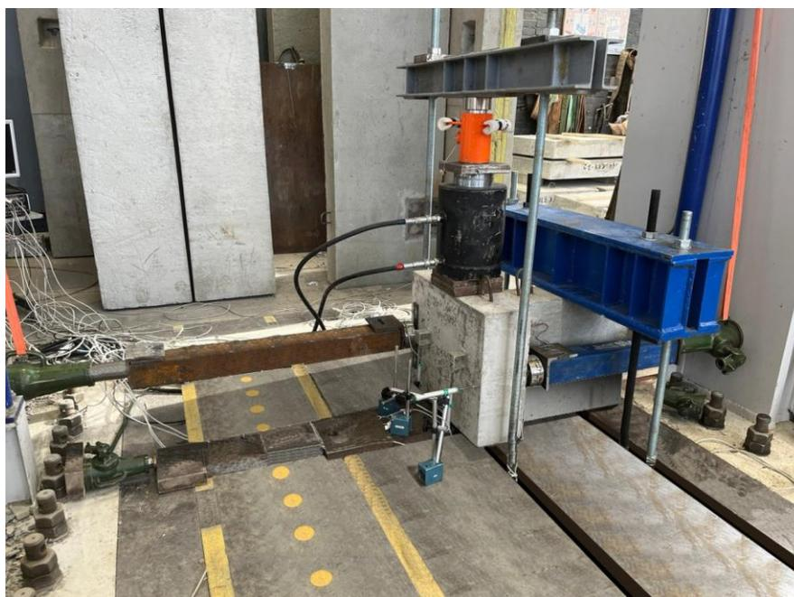
*Рисунок 2 – Общий вид установки при испытаниях на сдвиг с кручением*
