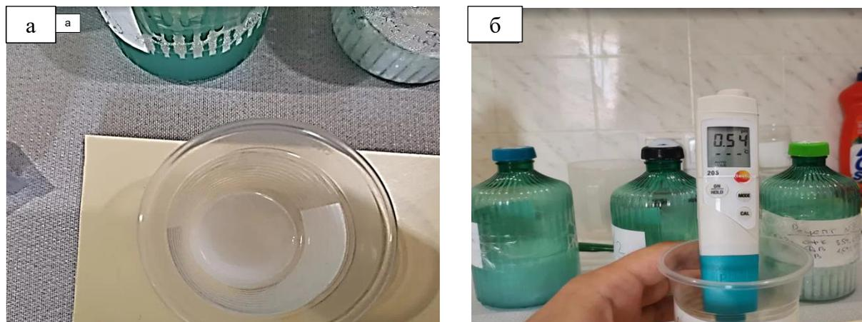
**Рисунок 4 – Сиропообразное состояние преобразователя коррозии №1 после заморозки при  $-18^{\circ}\text{C}$  (а); б) влияние отрицательной температуры на падение водородного показателя до отметки 0.54 для состава №1**
