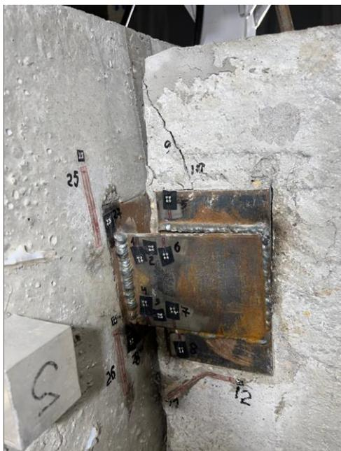
Рисунок 3 – Повреждения образцов при испытаниях на сдвиг
