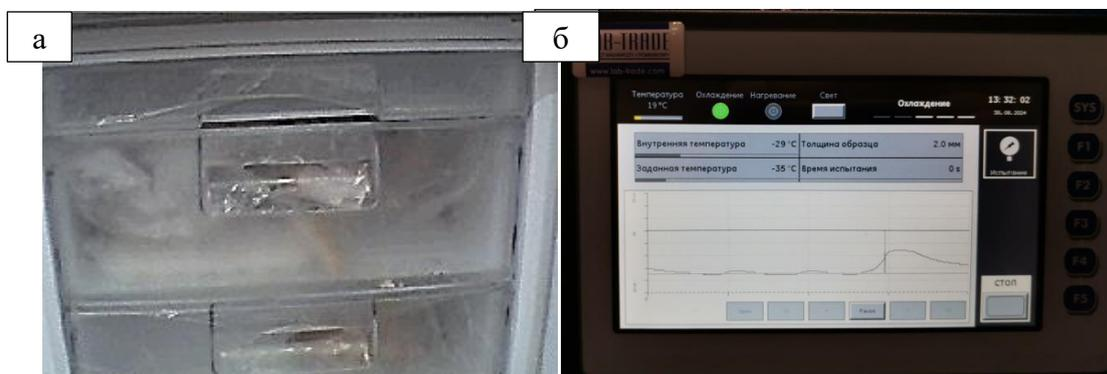
Рисунок 1 – Бытовая морозильная камера LG (а), температура  $-18^{\circ}\text{C}$ ; дисплей специализированной морозильной камеры LAB-TRADE KM 10 (б, температура замораживания  $-29^{\circ}\text{C}$ )
