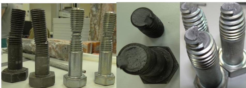
Рисунок 3 – Испытания болтов различных классов прочности
