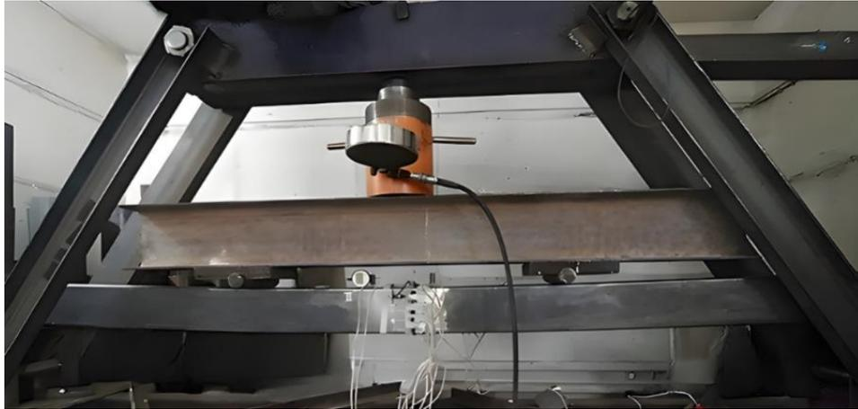
Рисунок 2 – Балка серии Б.ІІ в момент испытания
