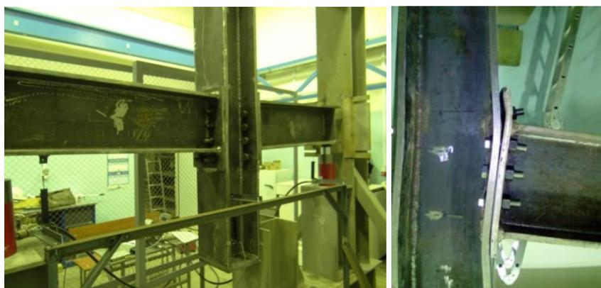
Рисунок 2 – Натурные испытания узлов фланцевых соединений
