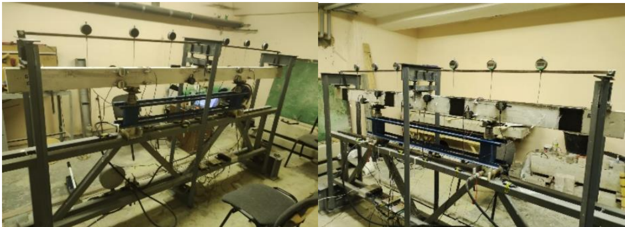
Рисунок 3 – Общий вид испытания до усиления углепластиком и после усиления
