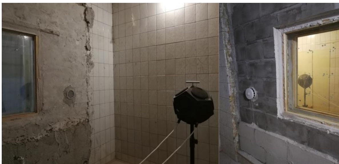
Рисунок 1 – Измерения звукоизоляции остеклений с клапаном КИВ 125 мм в реверберационных камерах Томского ГАСУ, вид из камеры низкого уровня и высокого уровня.
