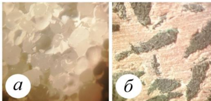
Рисунок 11 – Результаты исследования структуры образцов: а) с заполнителем в виде полиэтиленовых гранул, б) с заполнителем в виде дробленых отходов сшитого полиэтилена
