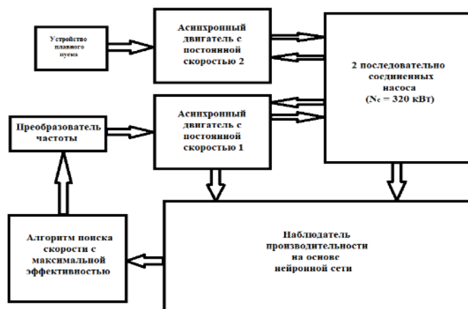
Рисунок 1 – Структурная схема нейруправления насосными агрегатами
