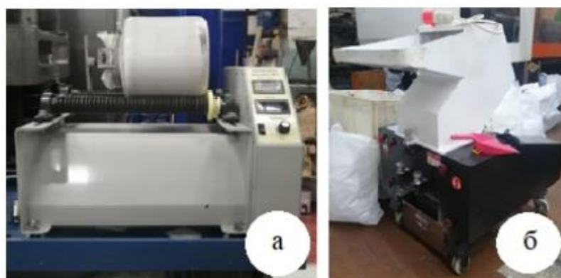
Рисунок 1 – Оборудование для подготовки отходов: а) лабораторная мельница ЛМ-2, б) измельчитель для пластмасс XFS-300
