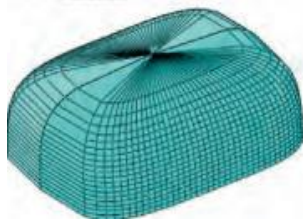
Рисунок 25 - Одна из поверхностей тройки с одинаковыми окружностями в основании и с одинаковыми суперэллипсами в вертикальных координатных плоскостях
