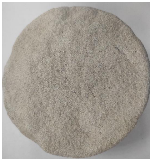
Рисунок 6 - Образец грунтобетона (пропитка ОТДВ – микроцемент тип №1), заметна высокая степень однородности массива, без промежуточных включений непропитанных участков песчаного грунта
