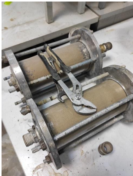
Рисунок 2 - Обработка односторонней модели в лабораторных условиях и перед нагнетанием на опытных участках строительной площадки
