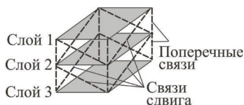
Рисунок 1 – Конечные элементы в слоях составной пластинки в трехслойной CLT-панели
