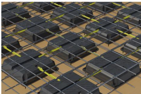
Рисунок 1 – Схема расположения пустотообразователей в железобетонной плите (а) и общий вид пустотообразователя (б)
