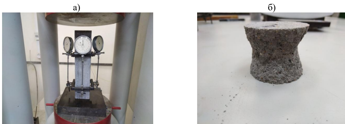
Рисунок 5 – Образец-призма в испытательной установке (а) и испытанный образец-цилиндр (б)
