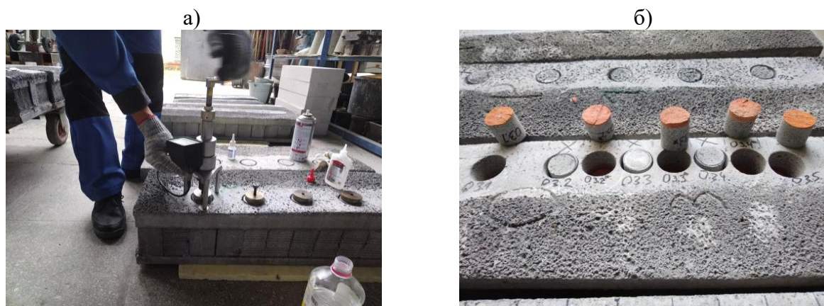
Рисунок 2 - Проведение испытания образцов на плите (а); образцы после испытания (б)
