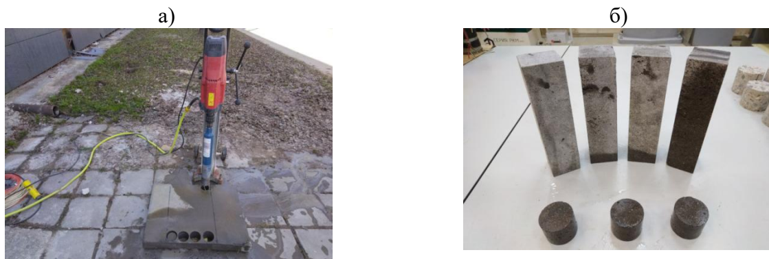
Рисунок 4 – Подготовка образцов (а) и вид образцов для испытаний (б)
