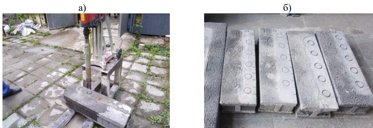
Рисунок 1 – Подготовка образцов для оценки прочности сцепления:
