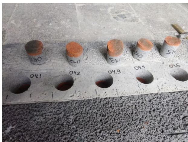
Рисунок 6 – Образцы после испытания (плита 04)
