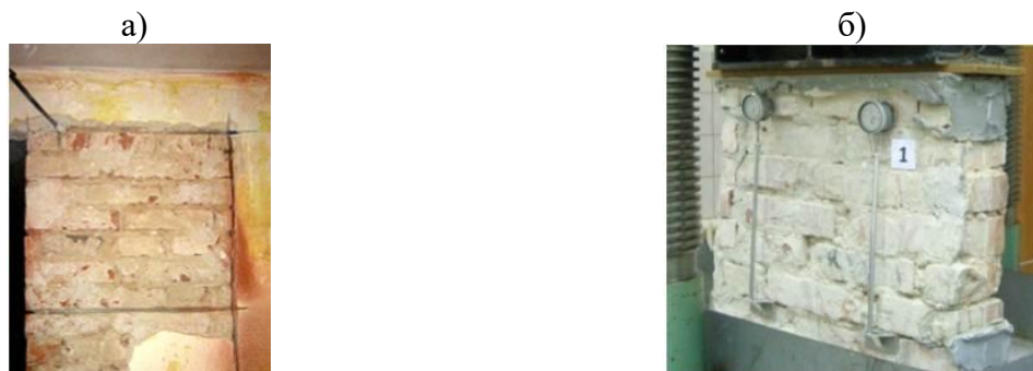
Рисунок 3 – Испытание образца каменной кладки: а) отбор образца кладки из стены; б) испытание каменной кладки на сжатие
