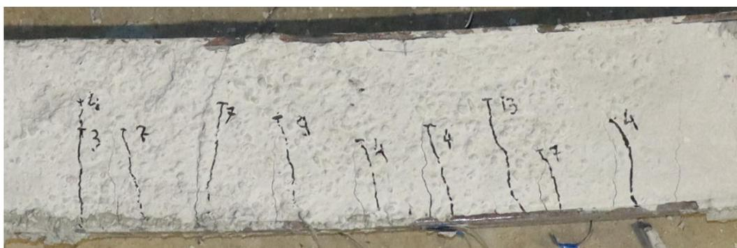
*Рисунок 8 – Характерный вид разрушенных моделей М2.1...М2.3:
