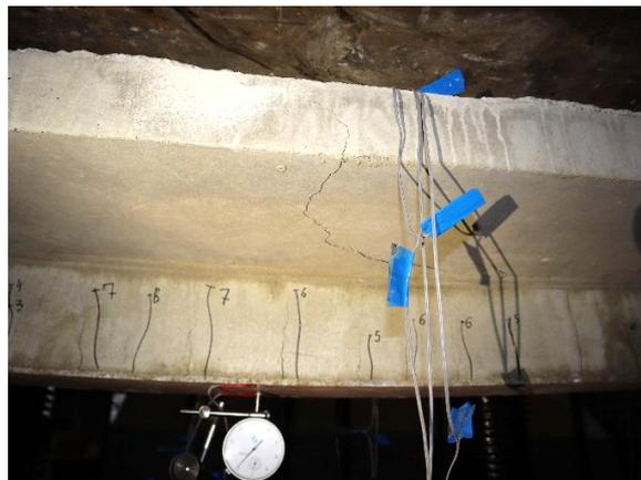
*Рисунок 9 – Характерный вид разрушенных моделей М2.4:
