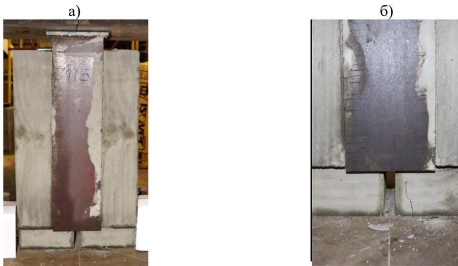
Рисунок 7 – Характерный вид разрушенных моделей М1:
