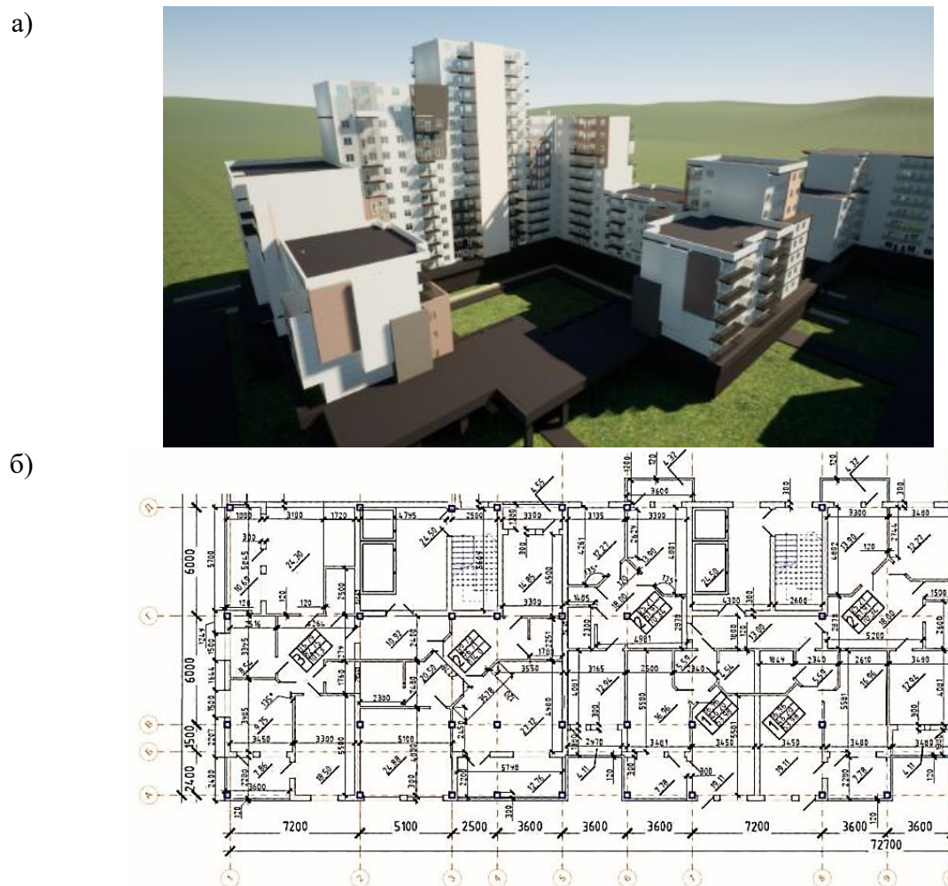
Рисунок 4 – Вариант жилого дома из индустриальных панельно-рамных элементов: общий вид (а); фрагмент плана (б)
