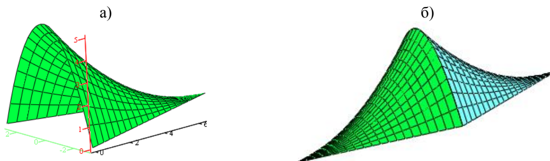
Рисунок 6 – Поверхность переноса на ромбическом плане с параболической образующей: а) случай 0 \leq x \leq L , б) случай -L \leq x \leq L
