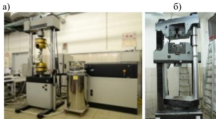
Рисунок 3 - Машины для испытаний: Instron 8802 (а), Instron 1000 HDX (б)
