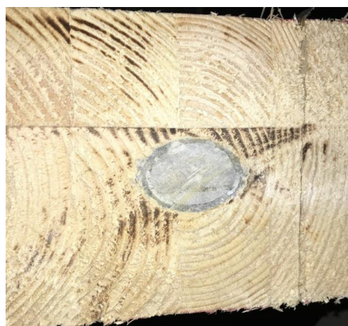
Рисунок 7 – Клеевое соединение стержня и древесины после испытаний
