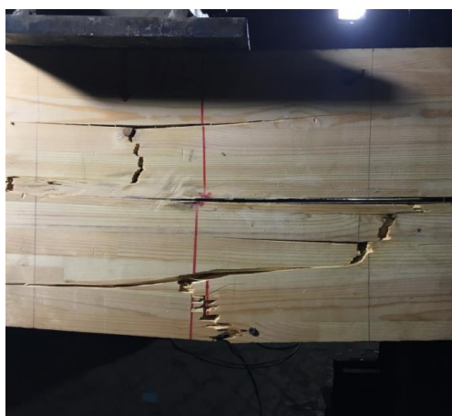
Рисунок 6 – Разрушение образца из-за разрыва волокон древесины
