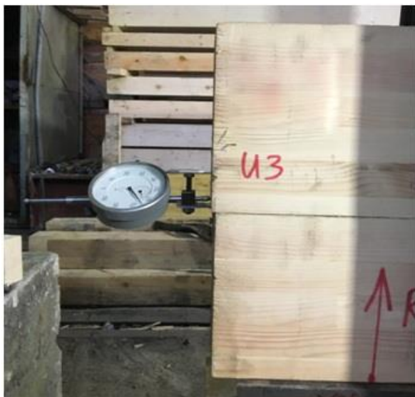
Рисунок 4 – Сдвиговые деформации на торце конструкции
