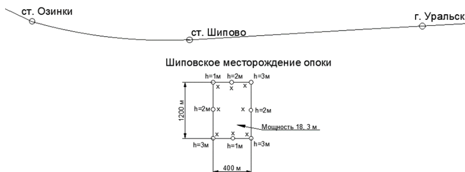
Рисунок 2 – Схема отбора проб опоки на Шиповском месторождении.
