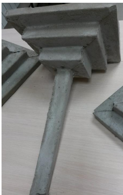
Рисунок 4 - Модель ступенчатой ж/б сваи длиной 1000 мм и 300×300 мм размерами сечения в верхней части
