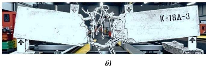
Рисунок 6 – К верификации методики расчета: расчетная схема в эксперименте (а), результат испытания (б)
