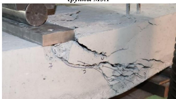
Рисунок 5 – Характерное разрушение моделей группы М3.5-3.7
