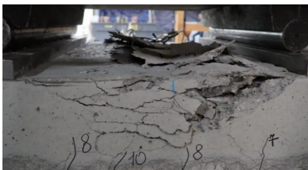
Рисунок 4 – Характерное разрушение моделей группы М3.2-3.4
