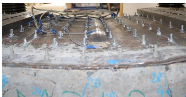
Рисунок 3 – Характерное разрушение моделей группы М3.1
