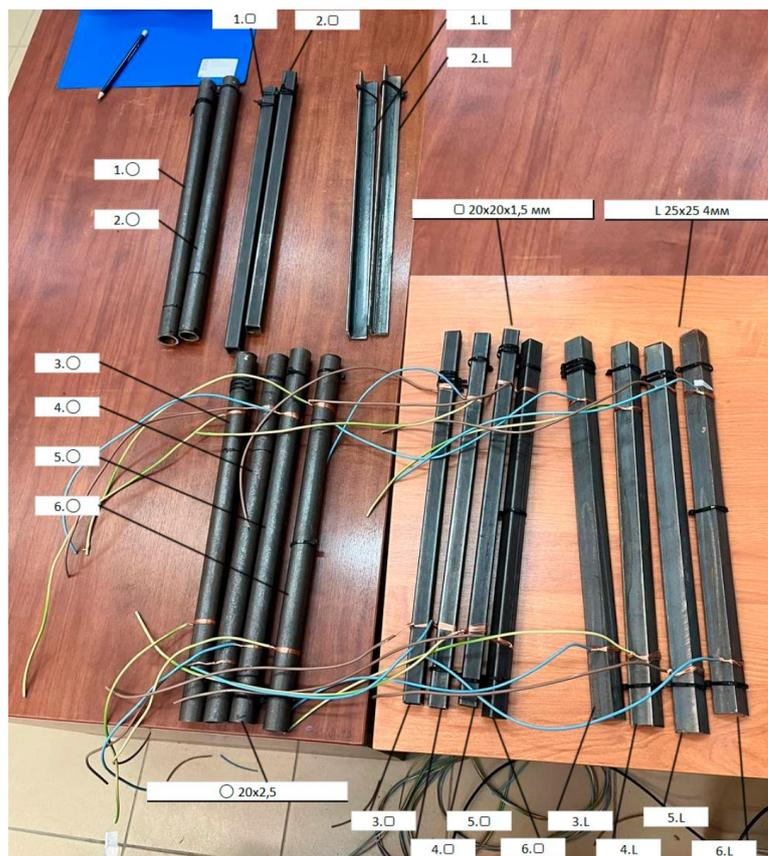
Рисунок 1 – Испытательные образцы по сериям
