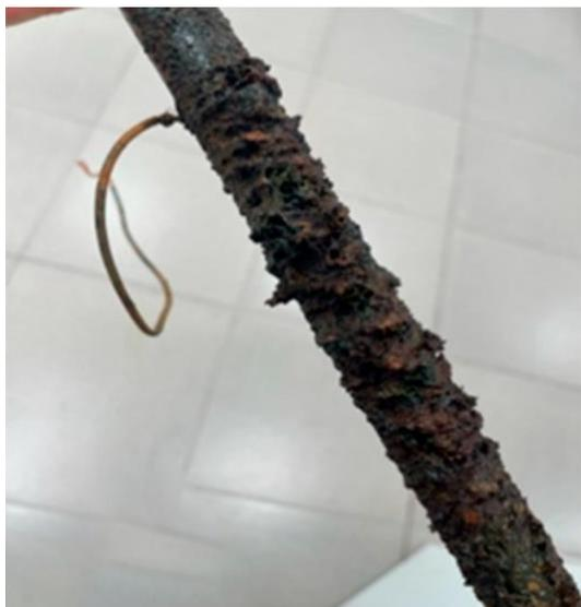
Рисунок 4 – Корродированный образец с продуктами коррозии
