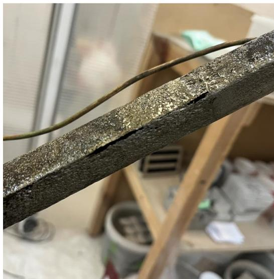
Рисунок 5 – Очищенный корродированный образец
