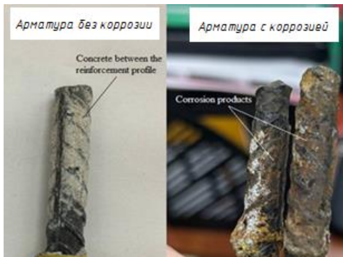
Рисунок 4 – Арматура с коррозией после испытаний
