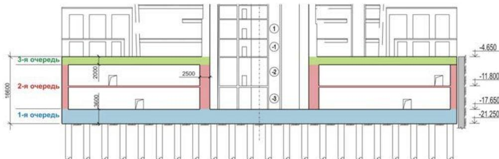
Рисунок 2. - Разрез коробчатого фундамента
