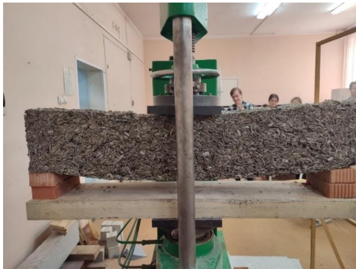
Рисунок 2 – Исследования прототипа армированной балки из ДЦК при изгибе
