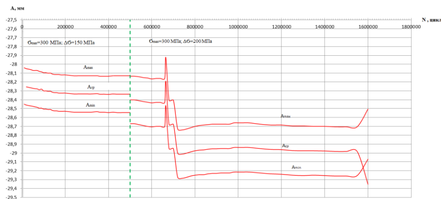
Рисунок 11 – Зависимость амплитуды перемещения активного захвата при циклических испытаниях арматуры A500C Ø16 мм в бетоне
