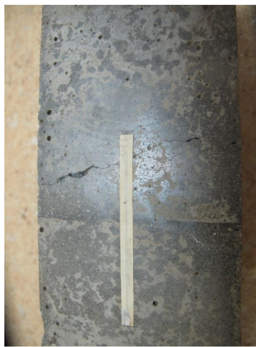
Рисунок 9 – Характер трещинообразования в бетоне контрольного образца муфтового соединения арматурного проката А500С Ø16 мм, забетонированного в бетонной призме (В60), при многократно повторяющихся циклических нагрузках
