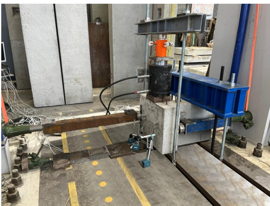
Рисунок 2 – Общий вид установки при испытаниях на сдвиг с кручением
