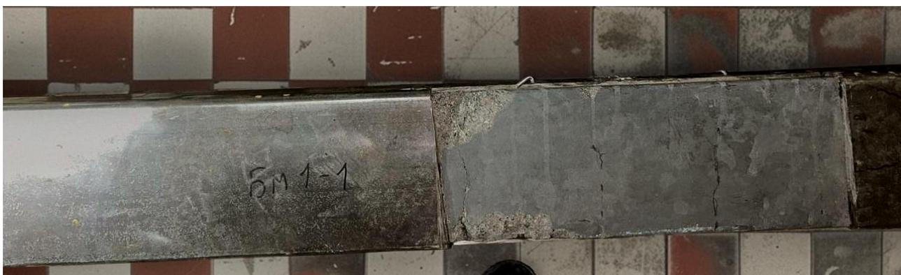
Рисунок 5 – Нормальные трещины в бетоне растянутой зоны балок
