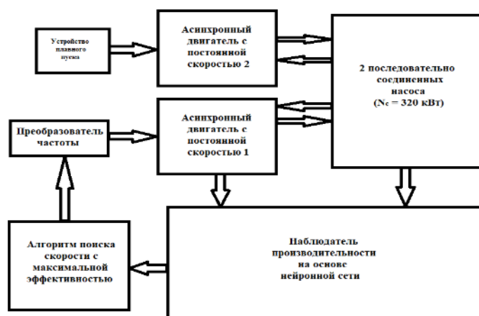
Рисунок 1 – Структурная схема нейруправления насосными агрегатами
