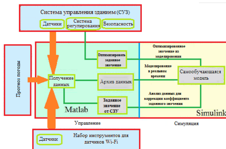
Рисунок 2 – Принципиальная схема интегрированной системы нейруправления в существующую систему автоматизации
