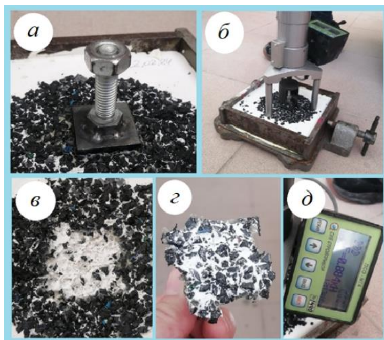
Рисунок 12 - Измерение адгезии частиц сшитого полиэтилена к цементной матрице с помощью прибора PCS-MG4: а) приклеенная отрывная пластина, б) испытание, в) место отрыва, г)оторванная пластина с частицами полиэтилена, д) измеренное значение
