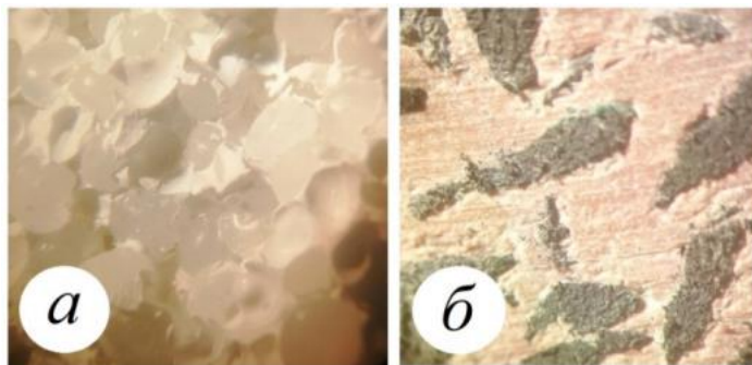
Рисунок 11 – Результаты исследования структуры образцов: а) с наполнителем в виде полиэтиленовых гранул, б) с наполнителем в виде дробленых отходов сшитого полиэтилена
