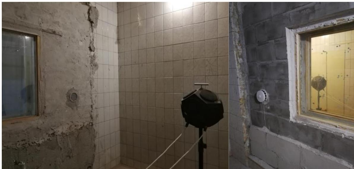
*Рисунок 1 – Измерения звукоизоляции остеклений с клапаном КИВ 125 мм в реверберационных камерах Томского ГАСУ, вид из камеры низкого уровня и высокого уровня.*
