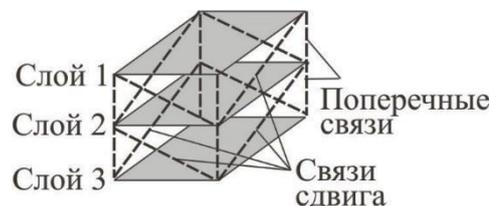
Рисунок 2 – Конечно-элементная модель плиты из ДПК
