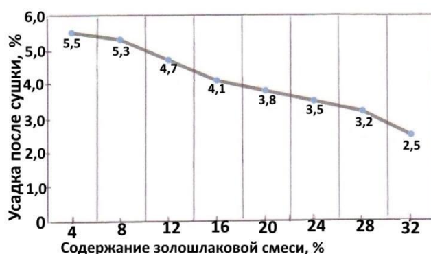
Рисунок 3 – Зависимость усадки после сушке от содержания золошлаковой смеси
