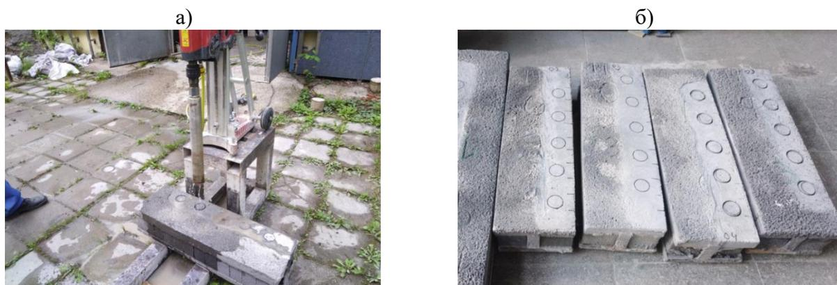
Рисунок 1 – Подготовка образцов для оценки прочности сцепления:
