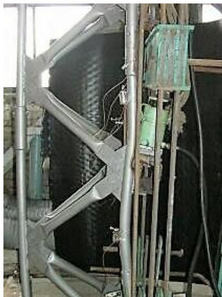
Рисунок 4 – Определительные испытания пространственно-стержневых конструкций: а) ферма-балка; б) стойка
