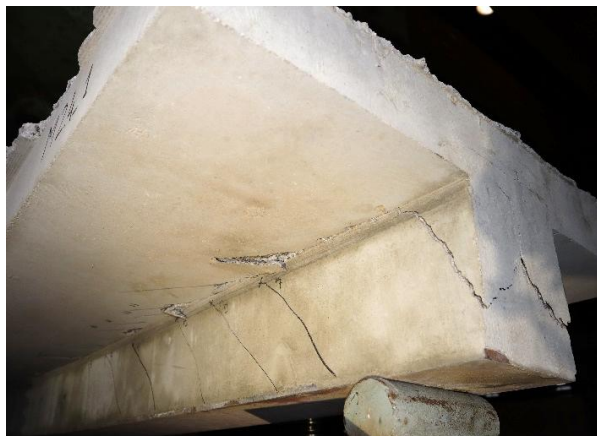
Рисунок 9 – Характерный вид разрушенных моделей М2.4: а) общий вид модели под нагрузкой перед разрушением; б) характерное разрушение
