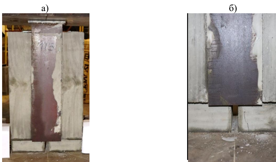
Рисунок 7 – Характерный вид разрушенных моделей М1: а) общий вид модели после разрушения; б) характерное разрушение моделей (сдвиг)
