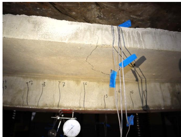
Рисунок 9 – Характерный вид разрушенных моделей М2.4: а) общий вид модели под нагрузкой перед разрушением; б) характерное разрушение
