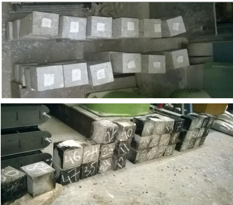
Рисунок 2 – Образцы до огневых испытаний (вверху) и после (внизу)
