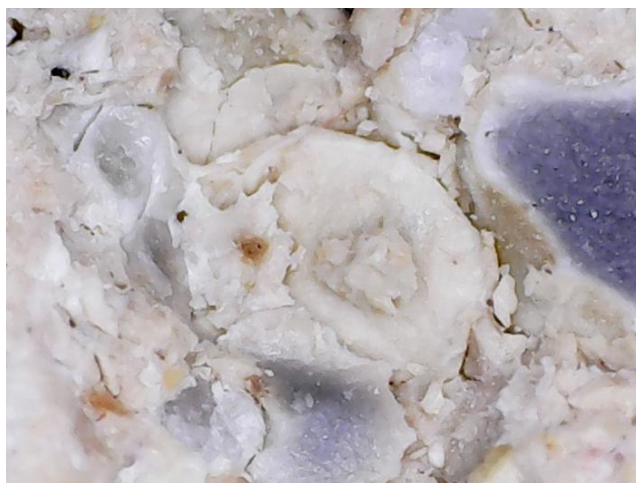
Рисунок 4 – Микроструктура цементного камня на основе силикатнатриевого вяжущего с добавкой 10% алюмохромистого отхода (микрофото М.Н. Барановой)
