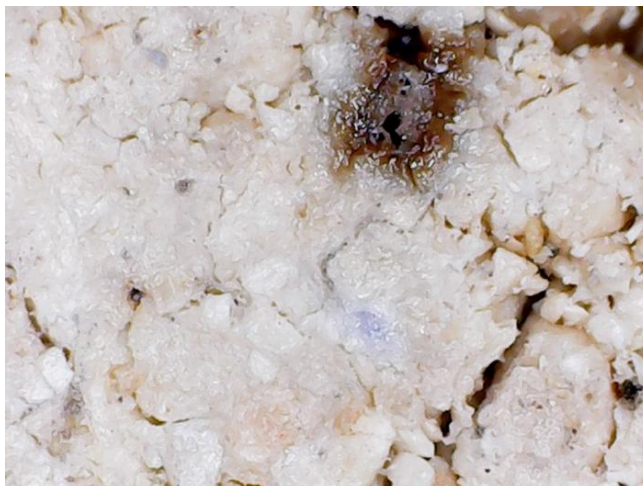
Рисунок 5 – Микроструктура цементного камня на основе алюмокальцевого вяжущего с добавкой 10% алюмохромистого отхода (микрофото М.Н. Барановой)
