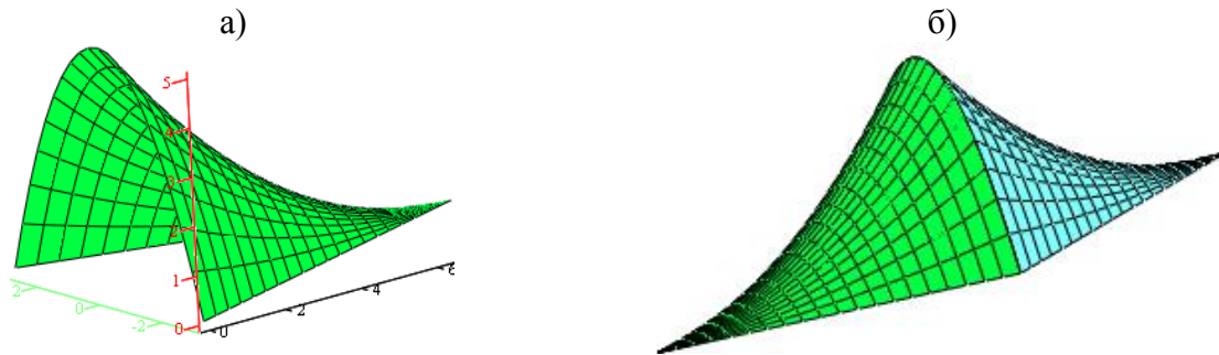
Рисунок 6 – Поверхность переноса на ромбическом плане с параболической образующей: а) случай 0 \leq x \leq L , б) случай -L \leq x \leq L
