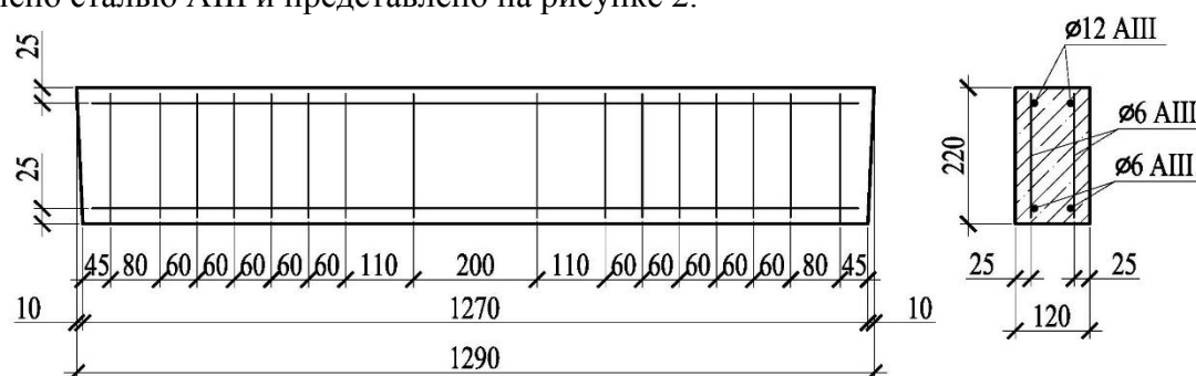
Рисунок 2 – Опалубочный чертеж и схема армирования образцов
