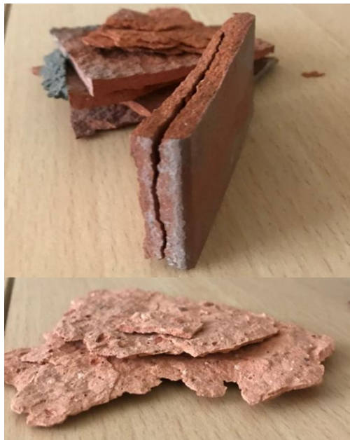
Рисунок 2 - Характер повреждений лицевого кирпича - расслоение
