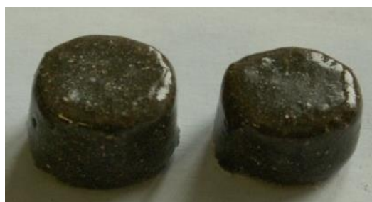
Рисунок 4 – Образцы стеклогранулята после термообработки
