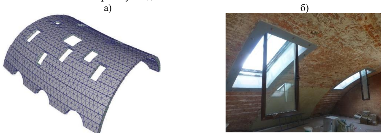
Рисунок 5 - Расчетная конечно-элементная схема свода (а) с видом выполненных оконных проемов (б)
