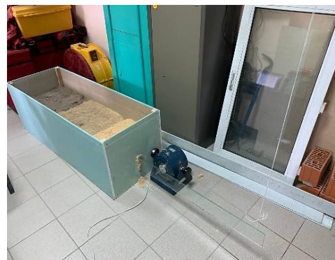
Рисунок 1 - Схема установки для измерения длины изгибной волны в полубесконечном стержне:
