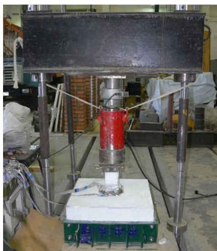
Рисунок 3 - Установка для испытания плит на продавливание
