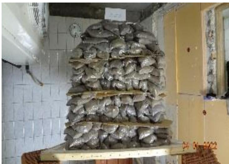
*Рисунок 7 - Силовые испытания пленки ЭТФЭ на 16 этапе загрузки при положительной температуре*
