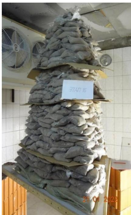
*Рисунок 8 - Силовые испытания пленки ЭТФЭ на 16 этапе загрузки при отрицательной температуре*
