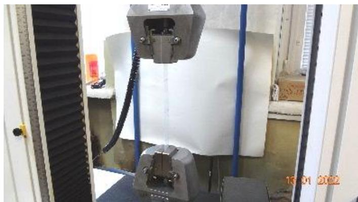
**Рисунок 4 - Силовые испытания пленки ЭТФЭ**
