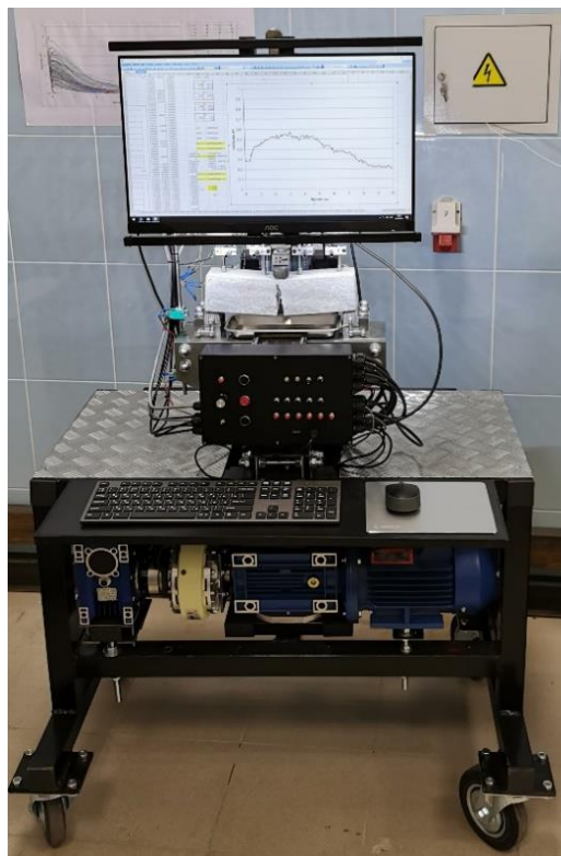
Рисунок 2 – Установка для проведения испытаний по определению характеристик трещиностойкости бетонных и фибробетонных образцов
