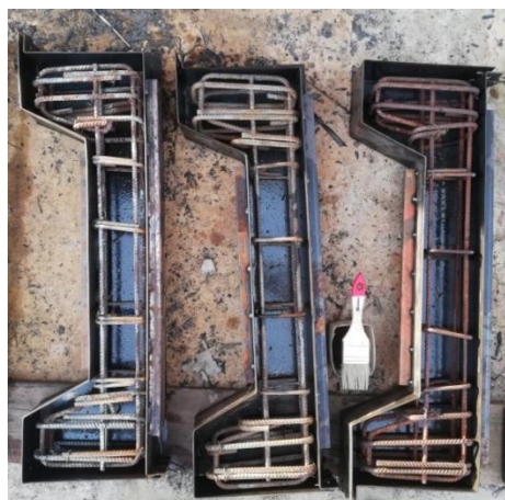
Рисунок 1 - Железобетонные образцы: а) каркас образца в опалубке; б) изготовленный железобетонный образец
