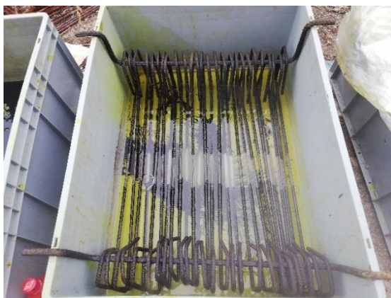
Рисунок 2 – Корродирование элементов: а) арматурные стержни, погруженные в раствор кислоты; б) ЖБ образцы, погруженные в раствор кислоты
