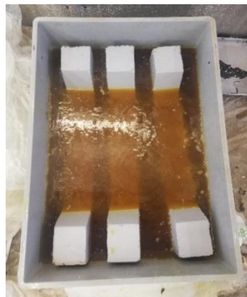
Рисунок 2 – Корродирование элементов: а) арматурные стержни, погруженные в раствор кислоты; б) ЖБ образцы, погруженные в раствор кислоты
