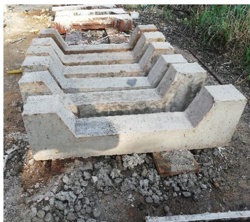
Рисунок 1 - Железобетонные образцы: а) каркас образца в опалубке; б) изготовленный железобетонный образец
