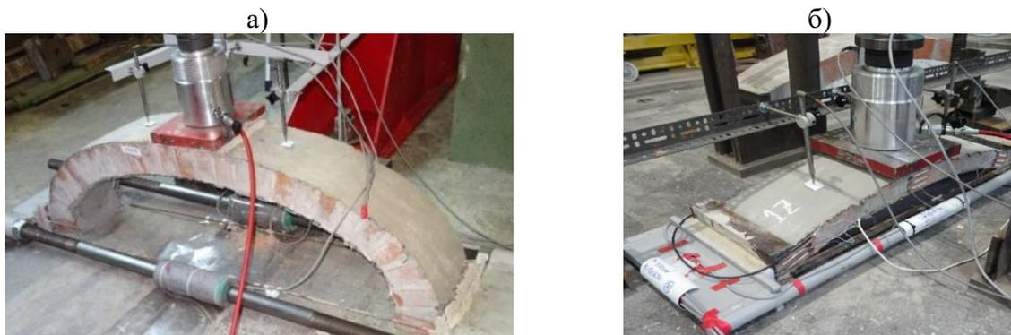
Рисунок 6 – Вид армированных образцов сводов в процессе испытаний
